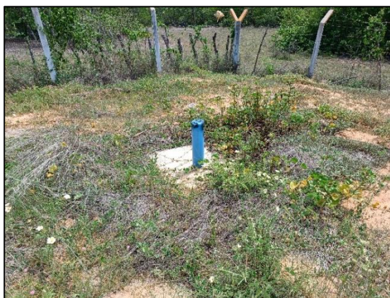
Figura 61 – Dispositivos de monitoramento de contaminação
